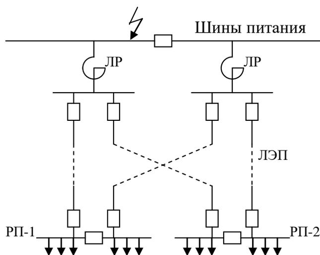
Рисунок 3. Схема к практической работе «Выбор групповых линейных реакторов»
